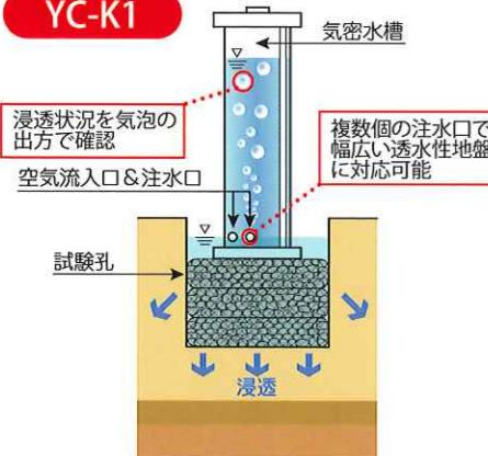
マリオットサイフォンの原理を満たした簡単な装置を開発しました。複数個の注水口を設ける事により、幅広い透水性地盤に適応できるようになりました。
