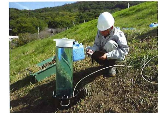
（注目）透水係数の評価（測定）の誤りは、浸透流解析による堤体の安全性評価の誤りに直結します。
