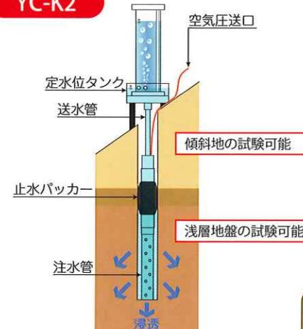
さらに、アタッチメントを取り付けると、従来装置で不可能とされていた地下水より上の浅層地盤（深度2～3m）の現場透水試験が可能になりました。
