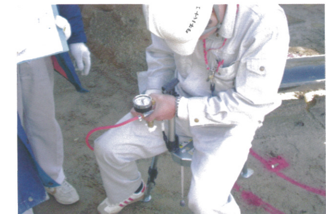
アーチカルバートの基礎確認（全2ヶ所） ※他にも多くの実績があります。
