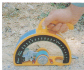
③地盤支持力テスト
