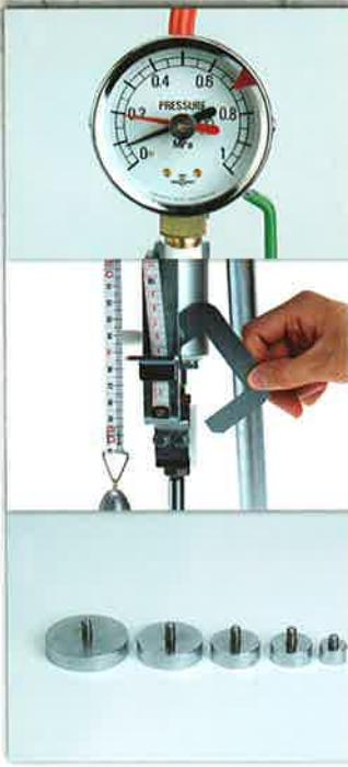
やり難い やれない 平板載荷試験を補います。段階毎に加圧し、沈下量とグラフによる計測を行います。計測を10点行い、その場で判定します。
